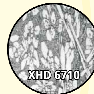
Estrutura Hipereutética com austenita primária e Carbonetos M_7C_3 - 5,0 % C - 45,0 % Cr
