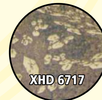
Estrutura Hipereutética com austenita primária e Carbonetos M_7C_3 - 5,0 % C - 35,0 % Cr
