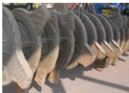
Solução convencional após 10 meses de operação, rotor completamente desgastado
