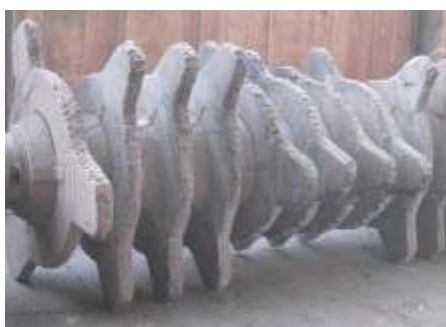
Tecnologia E3 após 37 meses, o rotor ainda está em boas condições
