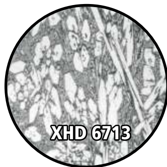
Estrutura hpereutética com Carbonetos Cr e B em matriz austenítica
