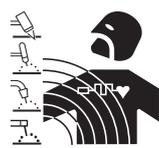
A corrente elétrica que atravessa qualquer condutor produz campos eletromagnéticos (EMF). A corrente de soldagem, ou de corte, gera campos eletromagnéticos ao redor dos cabos e dos geradores.
